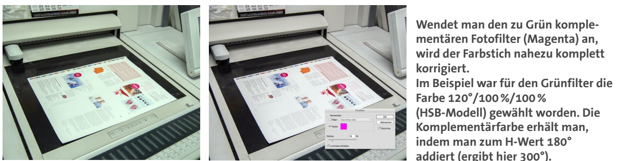
Abb. 5.7.1 | Beispiele für das Erzeugen (Reihe 1) und Korrigieren (Reihen 2 bis 4) eines Farbstichs.
