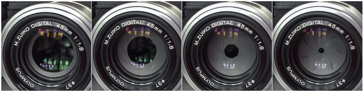
Abb. 3.2.1 | Unterschiedlich weit geöffnete Blende.
