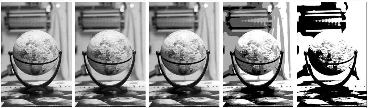
Abb. 4.1.4.1 | Graustufenbild mit 8, 7, 4, 2 und 1 bit Farbtiefe (entsprechend 256, 128, 16, 4 und 2 Graustufen).
